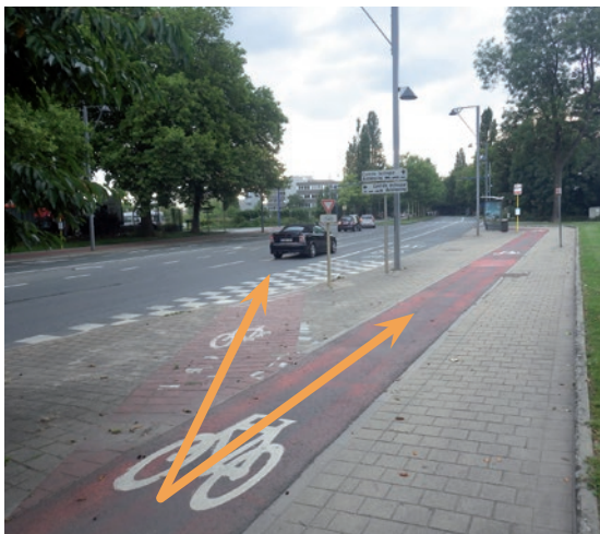
Figure 1 – Boulevard Paepsem – Les cyclistes peuvent ici soit suivre la piste cyclable marquée à gauche, et ensuite continuer tout droit sur la bande franchissable réservée aux bus, soit suivre la piste cyclable non visible sur la photo.
