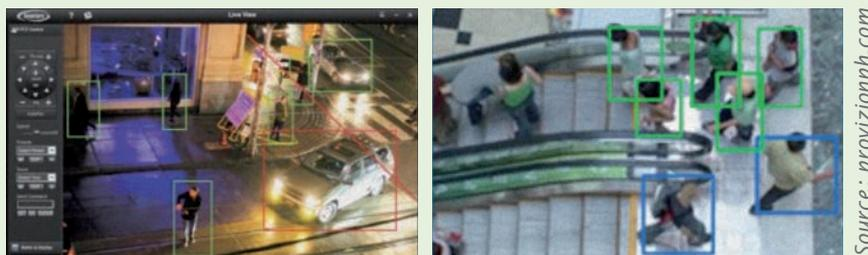
**Figure 6 – Illustrations du traitement de comptages automatisés par caméra vidéo**
