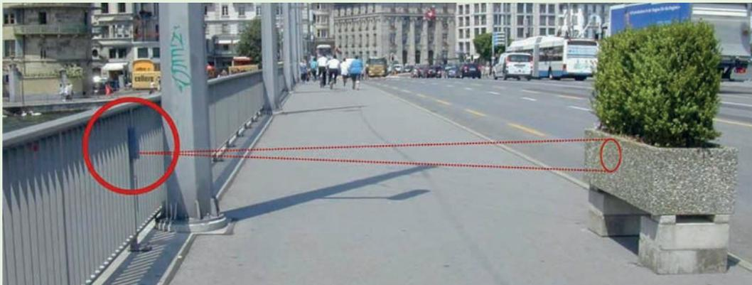
**Figure 9 – Exemple d'utilisation d'un capteur IR passif (source: Stadt Luzern, 2012)**
