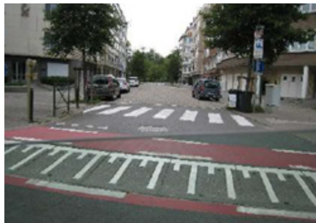
Figure 2 : Passage pour piétons surélevé [CRR 2020]
