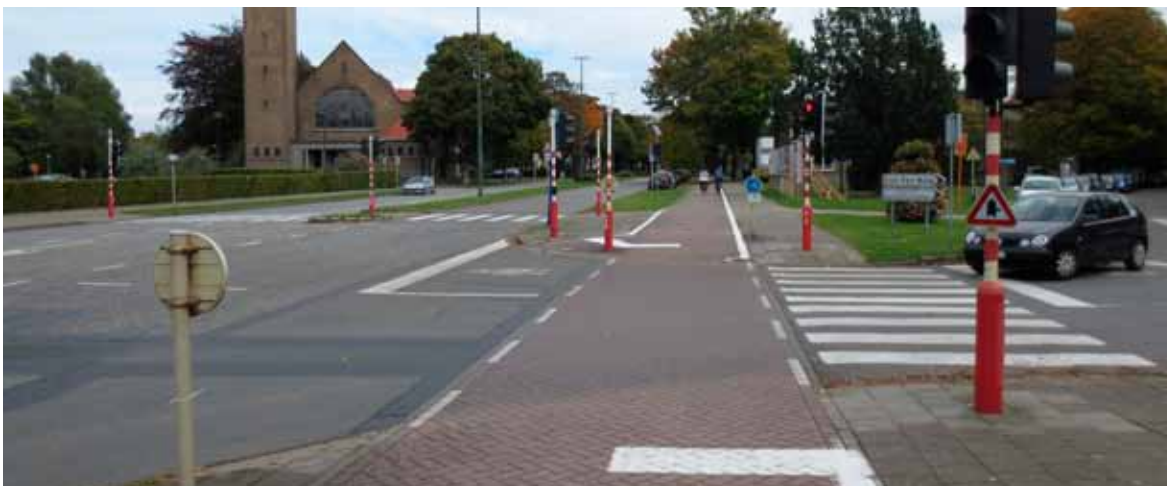
Fig. 5.43. Un dispositif en marquage permet le tourne-à-gauche (qui n'est pas indirect dans ce cas) depuis la piste cyclable bidirectionnelle de l'avenue Emile Vandervelde vers l'avenue Chapelle-aux-champs (vers le haut), non pourvue d'une piste cyclable.
