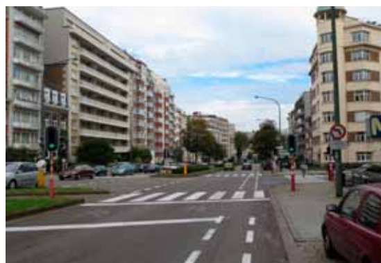
Fig. 5.3. Sur cet axe prioritaire, la PCM est prolongée dans le carrefour à feux (av. de Broqueville).
