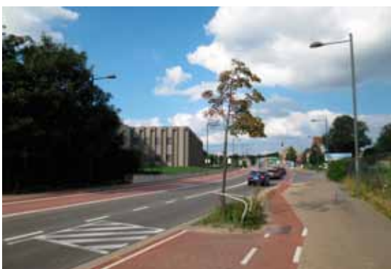
Fig. 5.2. Pour une bonne visibilité des véhicules qui tournent à droite, la piste cyclable séparée se rapproche de la chaussée et, dans ce cas, devient une piste cyclable marquée sur la traversée du carrefour (chée de Haecht).
