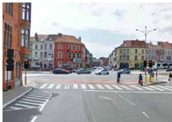
Fig. 5.41. et fig. 5.42. Tourne-à-gauche indirect avec feu spécifique pour les cyclistes (Gand, Citadellaan) .
