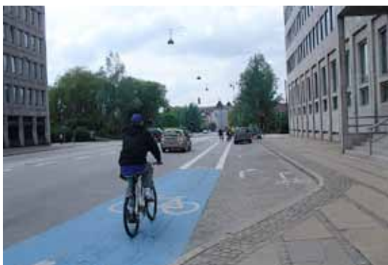
Fig. 5.12. Dans ce carrefour à Copenhague, les intentions du cycliste sont mises en évidence par le marquage, et le point de conflit entre les cyclistes circulant tout droit et les automobilistes est renforcé par un revêtement coloré.
