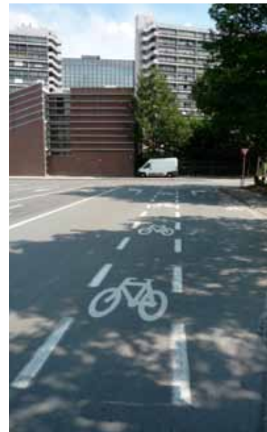
Figure 4.11. Dans ce carrefour à cédez-le-passage, une bande de tourne-à-droite pour le trafic général a été aménagée à la droite de la piste cyclable.
