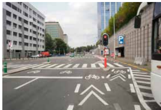
Fig. 5.15. Les cyclistes qui continuent tout droit ne sont pas soumis au feu, situé à leur gauche, mais doivent bien entendu céder le passage aux piétons. Des flèches de présélection à destination des cyclistes seraient utiles dans ce cas. La ligne stop située à droite du feu ne devrait pas être marquée (Bd Pachéco).
