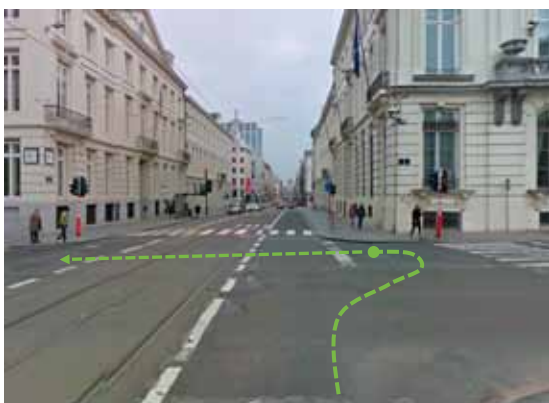
Fig. 5.24. La présence de voies de tram au centre de la chaussée rend inconfortable l'attente d'un cycliste souhaitant virer à gauche dans le carrefour depuis la rue Royale vers la rue des Colonies. Dans le cas illustré ici, la présence d'un feu de rappel pour le tourne-à-gauche indirect est préférable, mais pas indispensable car le cycle des feux est régulier. Source : maps.google.be.
