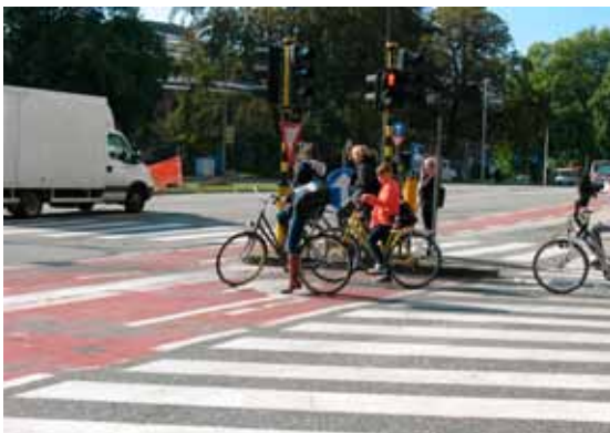
Fig. 5.41. et fig. 5.42. Tourne-à-gauche indirect avec feu spécifique pour les cyclistes (Gand, Citadellaan) .
