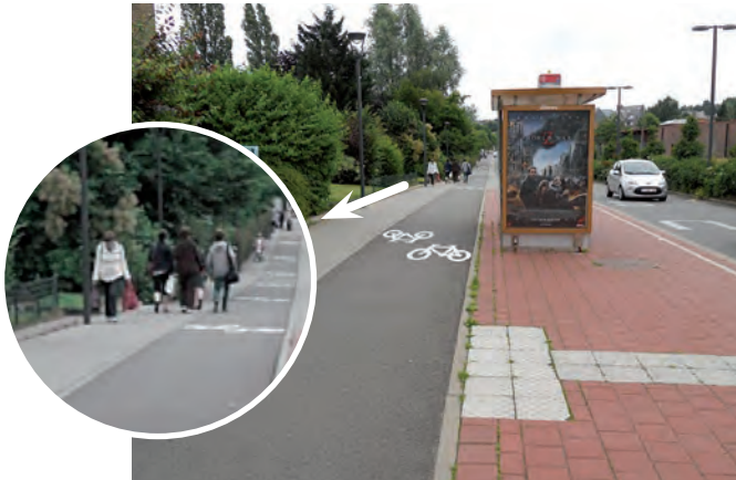
Figure 27 – Avenue Louis Dehoux, Auderghem, piste cyclable bidirectionnelle – Dans cet exemple de piste cyclable bidirectionnelle, la haie saillante constitue un obstacle sur le trottoir et, en l'absence de barrières à hauteur de l'abribus, d'éventuels conflits peuvent naître entre piétons et cyclistes. La piste cyclable bidirectionnelle est également sous-dimensionnée.
