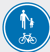
D10 – Partie de la voie publique réservée à la circulation des piétons et des cyclistes.
