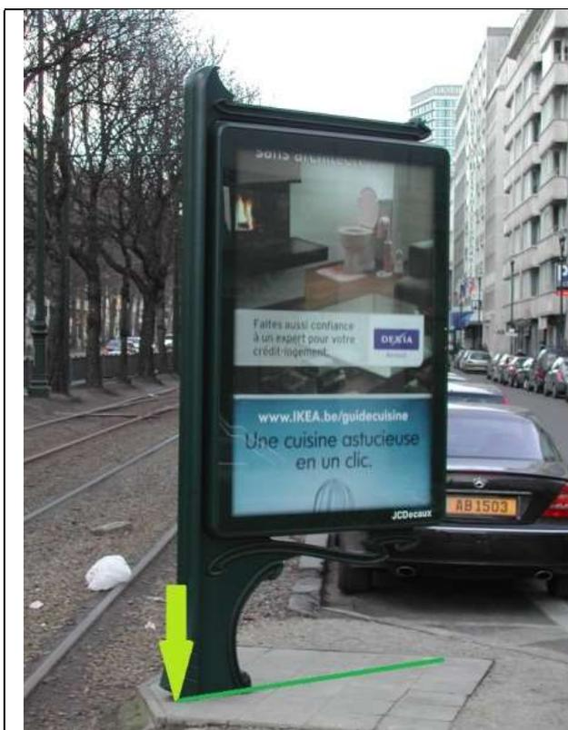
Les planimètres dont les dimensions  $\leq 1,2$  m sont relevés au pied de l'un des côtés (flèche verte) et représentés dans la couche « 388\_Planimetre » au moyen du BM388 » (orientation indiquée par la ligne verte).
