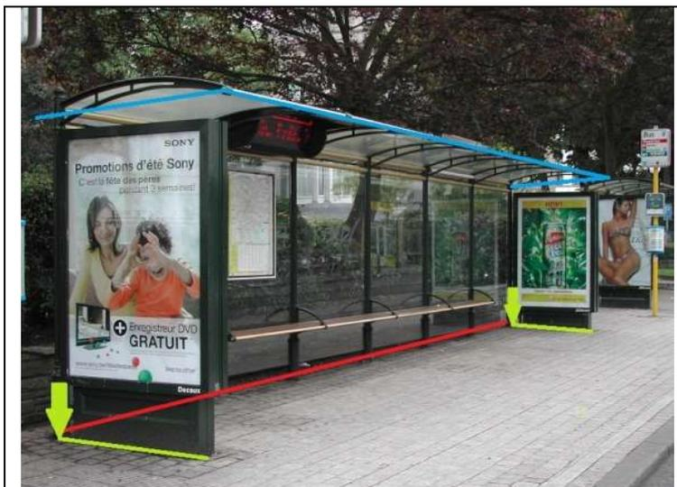
Les parois verticales des abribus sont relevées et représentées dans la couche « 329\_Abribus\_parois » (ligne rouge) au moyen d'éléments linéaires. Le relevé de ces parties est effectué au niveau du sol.
