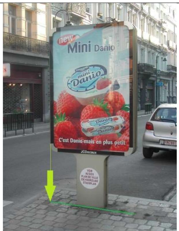
Les planimètres dont les dimensions  $\leq 1,2$  m sont relevés au pied de l'un des côtés (flèche verte) et représentés dans la couche « 388\_Planimetre » au moyen du symbole orienté « BM388 » (orientation indiquée par la ligne verte).
