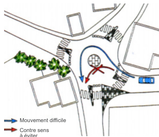
Figure 9 : Angle entre deux branches pour éviter la prise à contre sens [CERTU]
